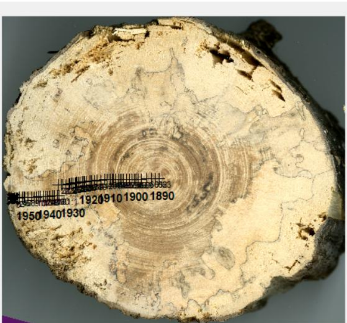
Фиг. 10. Сканирана шайба от експедиция от 2025 г и най-дългото възможно измерване.
